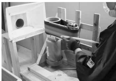
補助金を活用して導入した集塵機とベルトサンダーで製作する吉昭さん
